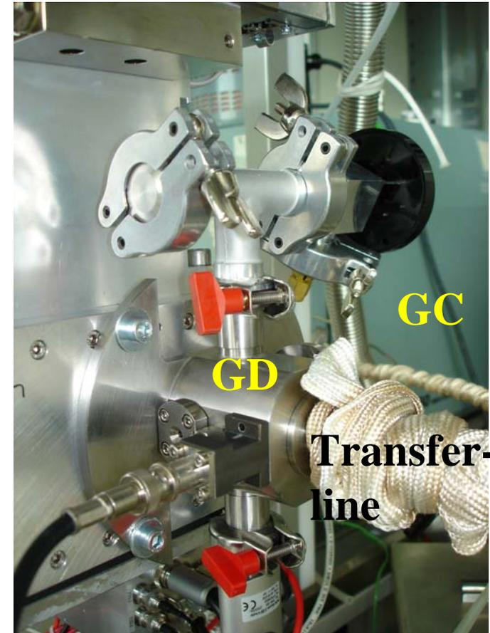
→ Modularer Aufbau auf optischen Tisch, ermöglicht die Kopplung des TOFMS an unterschiedliche Ionenquellen
