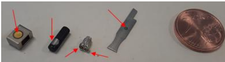
Proben mit Brennflecken verschiedener Größe neben einem 2-Cent-Stück zum Größenvergleich
